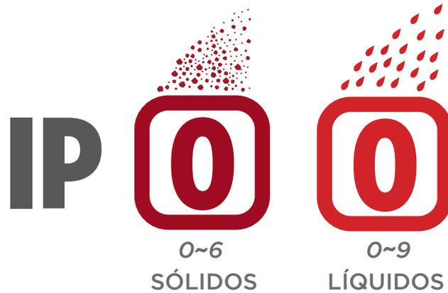
São medidas aplicadas ao invólucro de um equipamento elétrico, definida pela NORMA **ABNT NBR IEC 60529**.
