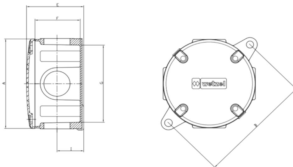
**DIMENSÕES CAIXA DIÂMETRO PEQUENO (mm)**
